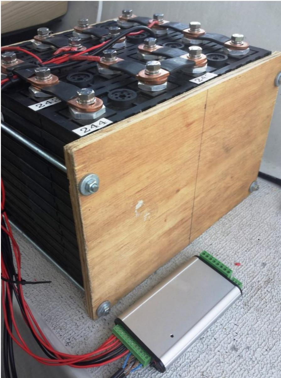
*Un dos de batterie au lithium DIY de 200 Ah pour un yacht connecté à un module de protection de batterie personnalisé.*
