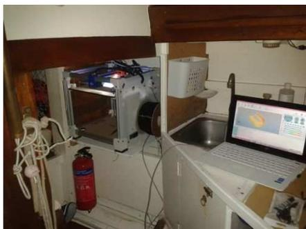
Ça y est, notre imprimante 3D est prête pour le voyage ! Elle a subi pas mal de modifications, changement de l'alimentation électrique pour la brancher sur l'électricité du bord, imperméabilisation des circuits électroniques, renforcement de la structure et montage d'un lecteur de cartes mémoire.
