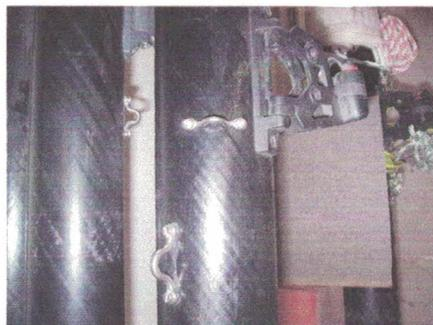
Placer le pontet au niveau de la ferrure inférieur du Palan de cuningam de grand voile et perpendiculaire à l'axe du mat.
