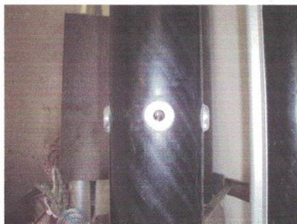
Placer la rondelle aluminium de la drisse de spi a 1,6 m de la tête de mat, sur sa partie avant (côté opposé à la ralingue aluminium).
