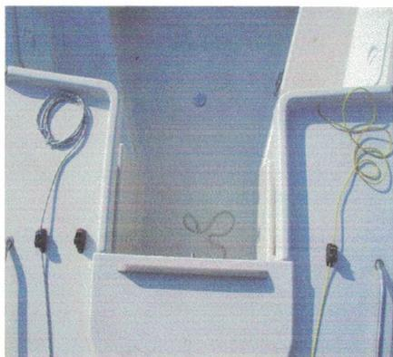
Placer le coinqueur d'amure de spi a mi distance entre le coinqueur d'enrouleur de mat et le bord du roof coter descente.
