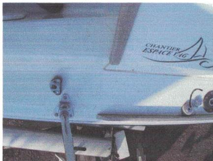
Placer le coinqueur au bord de l'anti-dérappant à côté du pied de chandelier arrière.
