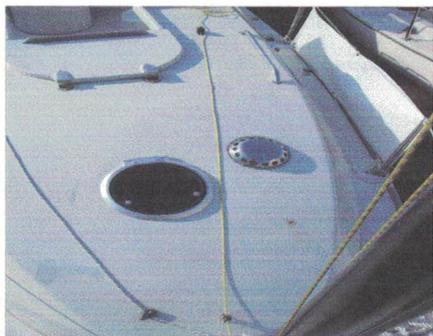
Placer l'axe du pontet de la poulie de renvoi de drisse de spi à 10 cm en arrière du bord du roof de façon que la drisse de spi face une ligne droite du mat jusqu'à son coinqueur et quelle passe entre le panneau de pont et l'aérateur de pont (pour les bateaux qui en sont équipés).
