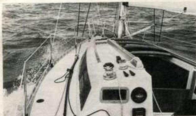
Un plan de pont fonctionnel, des passavents dégagés, un double capot de roof, le First 305 s'avère bien conçu pour la manœuvre en équipage réduit.
