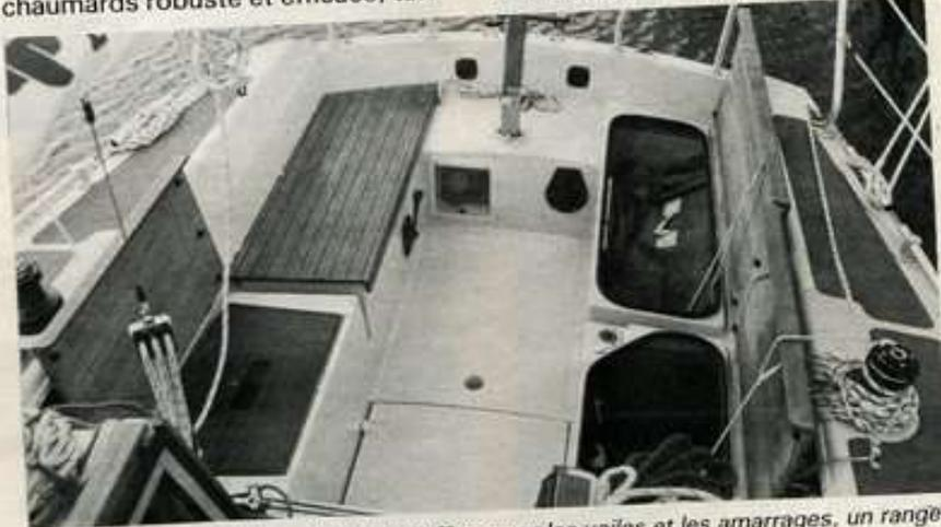
Dans le cockpit de l'Etap 30, deux coffres pour les voiles et les amarrages, un rangement pour le panneau de descente et pour la bouteille de gaz. Au fond, s'ouvre le capot moteur et vient se placer la table au port.
