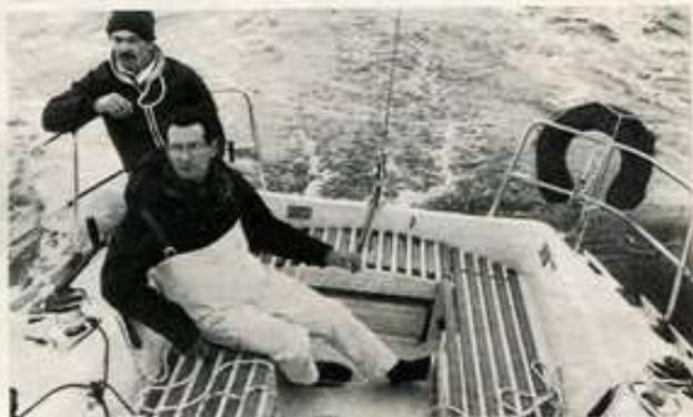
Le cockpit le plus confortable en mer. Sur le First 305, les taquets s'intègrent dans le dossier, les lattes de teck évitent l'eau stagnante, la manette moteur est protégée.
