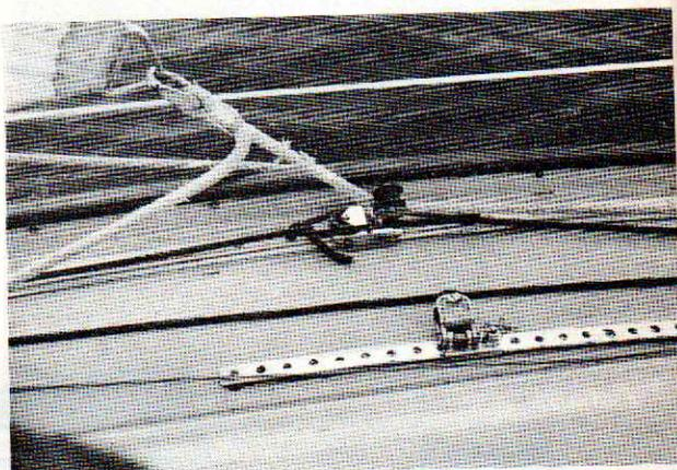
Le passavant et ses deux rails d'écoute équipés d'avale-tout. A noter sur le rail extérieur les retours permettant de régler en traction le point de titre du génois.
