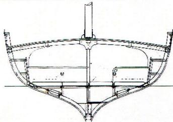
Le Shpountz sera offert en deux versions : l'une en bois moulé en quatre plis sur lice avec charpente lamellée et carène recouverte de
