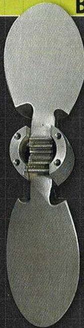
◀ La forme arrondie des pales permet de réduire la traînée au minimum en position repliée.
