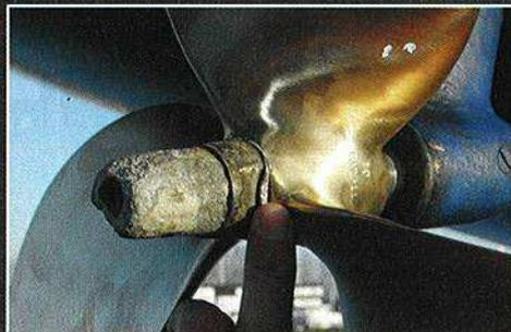
▲ On recourbe la rondelle sur l'écrou pour le bloquer. Notez l'état de l'anode, à changer sous peu.
