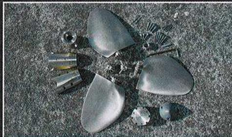
▲ Le montage de la Maxprop est un vrai Meccano, et il faut la démonter en partie pour régler le pas.
