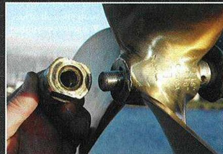
▲ L'hélice est tenue par un simple écrou vissé sur le cône : difficile de faire plus simple.
