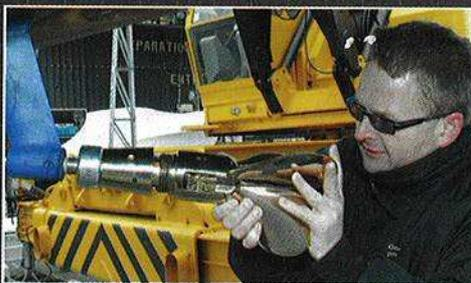
▲ L'hélice s'enchâsse dans le moyeu-embase qu'on a préalablement fixé au cône de l'arbre.
