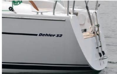
Le Dehler 32 a été stratifié à la main, sa coque et son pont construits en sandwich avec un noyau de balsa. Deux points importants ici: la liaison entre la coque et le pont n'est plus surlaminée comme sur les anciens modèles, mais simplement collée. Elle comporte ainsi une plinthe sur tout son long. Autre point important, les cadènes sont installées à l'extérieur de la coque, laissant ainsi les larges ponts latéraux totalement libres.
