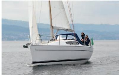
Le gréement équipé de deux paires de barres de flèches du Dehler 32 lui permet d'afficher une surface de voiles plutôt grande (60 m<sup>2</sup>) malgré son petit génois (107%). Le bateau démarre au quart de tour à la moindre brise et lorsque le vent forcé, il transforme rapidement la pression exercée sur les voiles en vitesse. S'il affiche une gîte importante, on s'y sent toujours en sécurité. La barre réagit tout en finesse au moindre mouvement.
