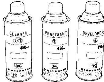
(3) Nettoyer la surface à contrôler avec le détergent. Vaporiser « le détergent » directement sur la surface, ou nettoyer avec un chiffon imbibé de ce produit.
