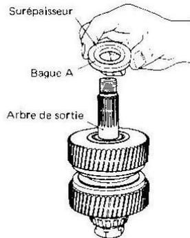
**NOTE :** Tourner la bague A dans le bon sens, c'est-à-dire que la surépaisseur s'applique contre le cône du Timken.
