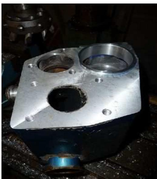
Finalement j'ai collé la frette au joint auto-bleu, quelques jours de séchage avant le remontage.
