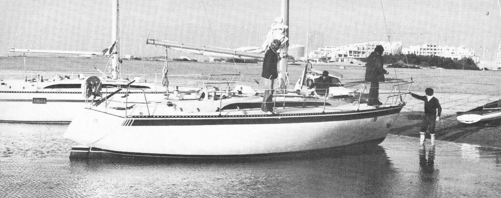
miner sur l'arrière par un aileron qui fait office de béquille lorsque le bateau repose au sec. Cet appendice volumineux s'apparente en fait à une longue quille qui apporte au bateau une bonne stabilité de route, mais permet également d'abaisser le centre de gravité en logeant le lest et le moteur au point le plus bas. La formule adoptée par l'architecte tend à faire disparaître le concept de manque de raideur que l'on attribue au dériveur.
