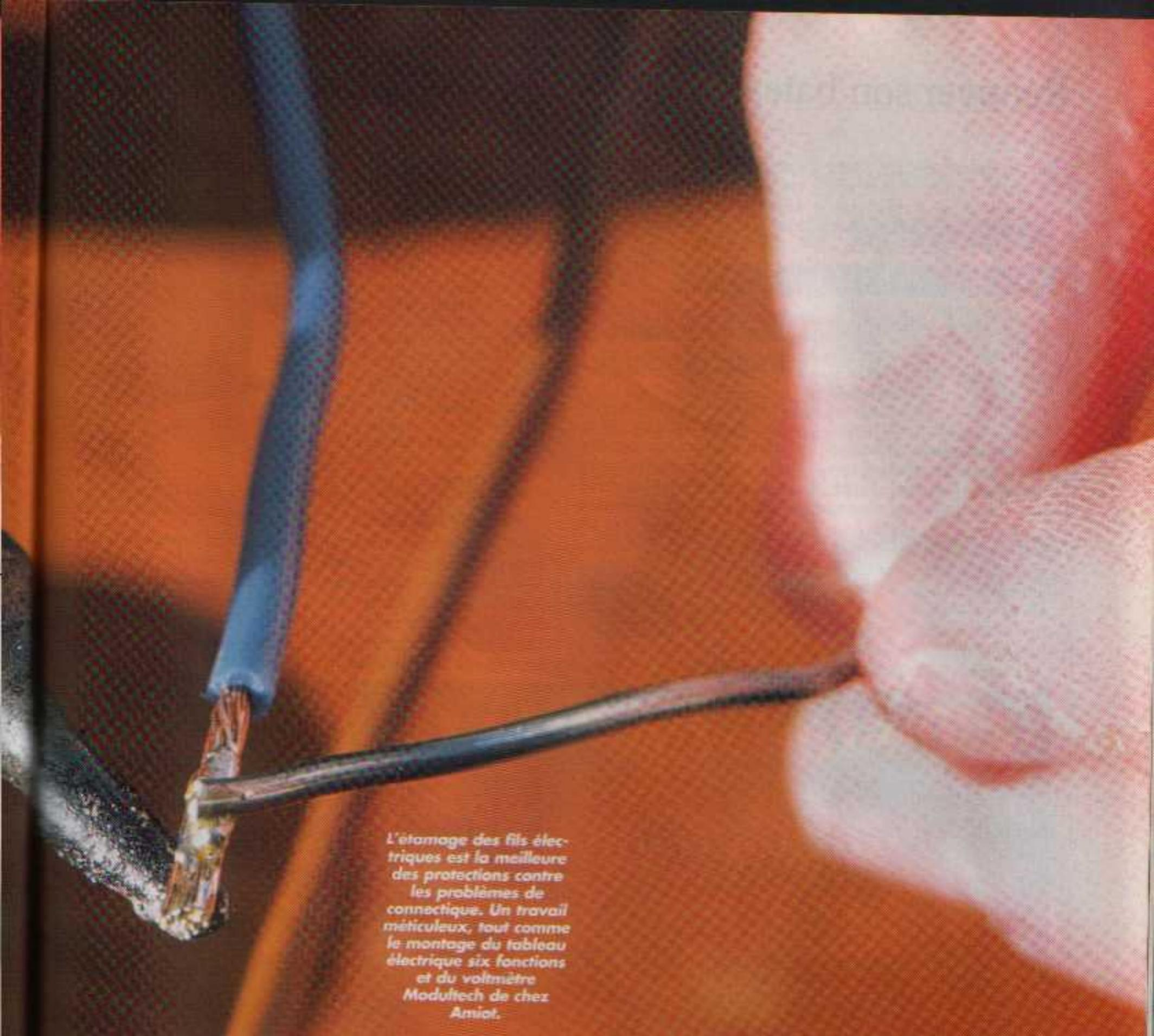
*L'étamage des fils électriques est la meilleure des protections contre les problèmes de connectique. Un travail méticuleux, tout comme le montage du tableau électrique six fonctions et du voltmètre Modultech de chez Amiot.*
