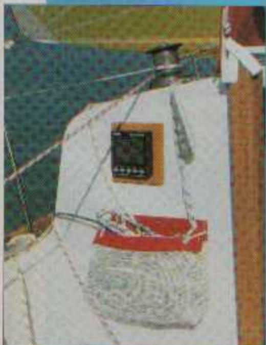
De part et d'autre du rouf, un sac à drisses (175 F) est fixé sur la paroi verticale à l'aide de trois vis.
