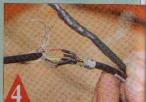
2 Si la platine de fixation du boîtier dotée d'un joint est étanche, il n'en va pas de même de notre support en teck que l'on étanchéifiera au Sikaflex 291 (2). Deux écrous blancs assurent le boîtier (3) de l'intérieur. Les connexions se font directement par des fiches. Mais, pour diminuer la longueur des câbles des deux sondes, nous les avons coupés puis raccordés (4)...
