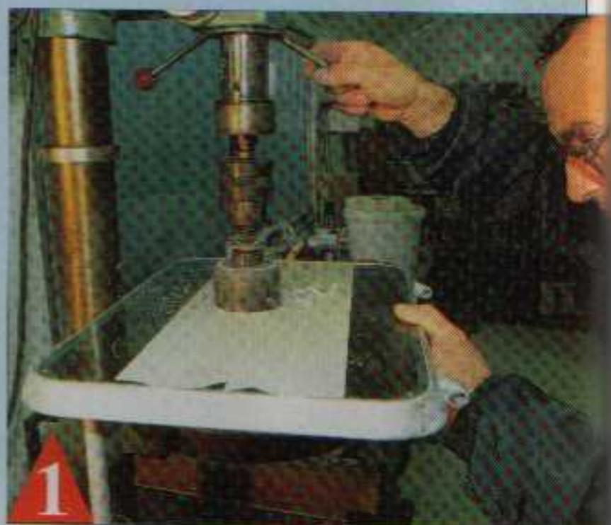
1 C'est avec une scie cloche de 65 mm montée sur une perceuse verticale que l'on percera le plexi du capot.
