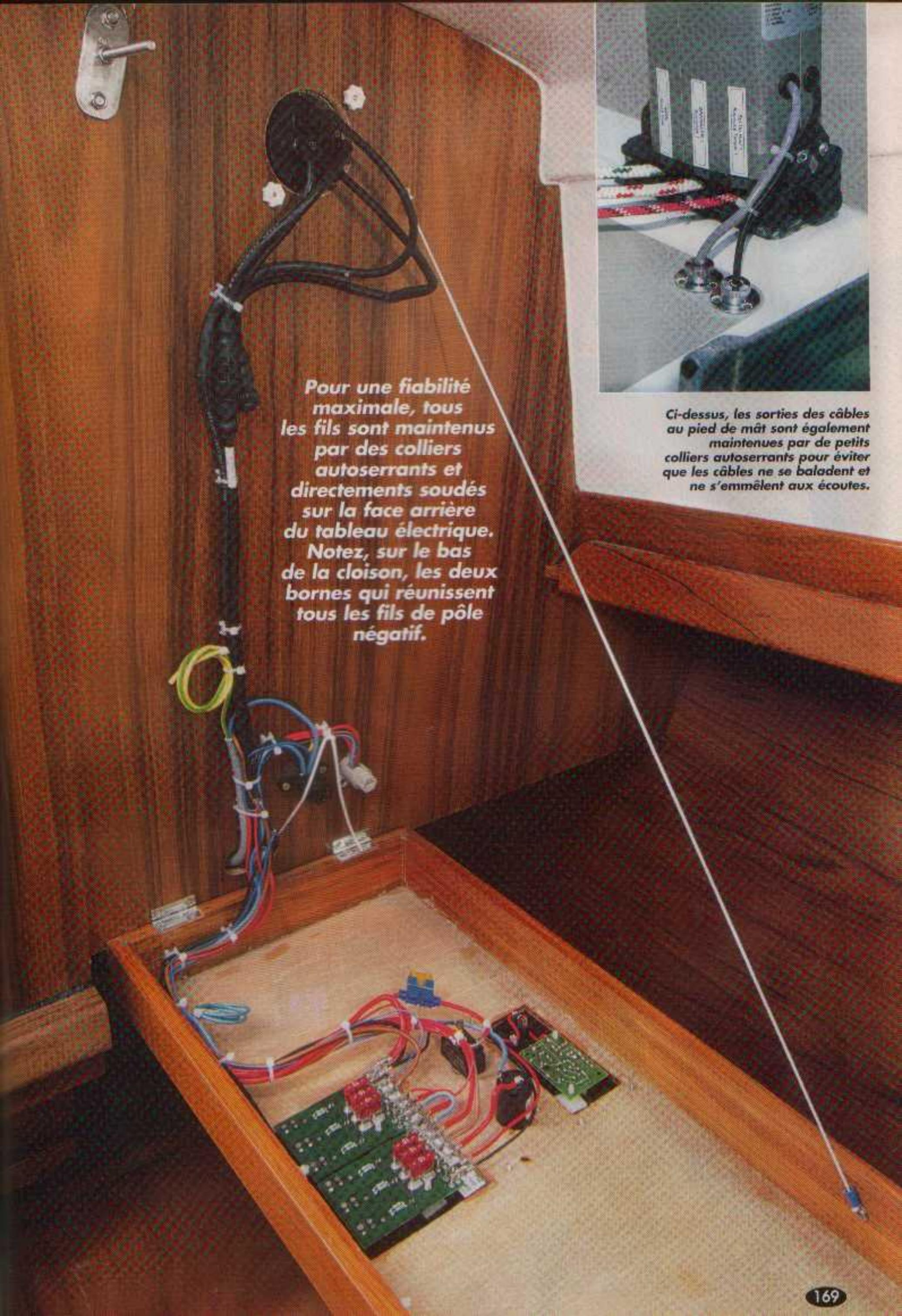
*Pour une fiabilité maximale, tous les fils sont maintenus par des colliers autoserrants et directement soudés sur la face arrière du tableau électrique. Notez, sur le bas de la cloison, les deux bornes qui réunissent tous les fils de pôle négatif.*
