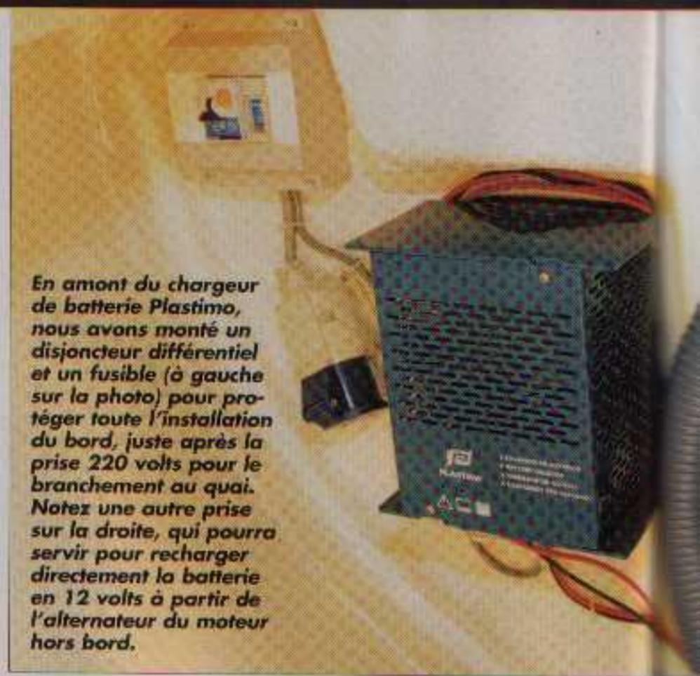
*En amont du chargeur de batterie Plastimo, nous avons monté un disjoncteur différentiel et un fusible (à gauche sur la photo) pour protéger toute l'installation du bord, juste après la prise 220 volts pour le branchement au quai. Notez une autre prise sur la droite, qui pourra servir pour recharger directement la batterie en 12 volts à partir de l'alternateur du moteur hors bord.*
