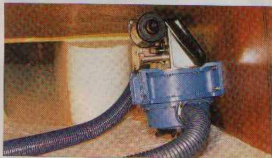
L'adoption d'une pompe de cale électrique placée sous le cockpit, qui utilise un moteur 12 volts accouplé à une pompe classique Plastimo, dotée de tuyaux de même diamètre (38 mm) que ceux de la pompe à bras, permet de tout uniformiser.
