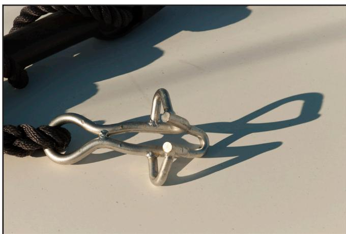
A ce propos, n'utilisez pas la main de fer Wichard, totalement inadaptée pour tenir sérieusement un mouillage; c'est une menotte de bébé pour temps de demoiselle. (rupture 3.000 Kg)
