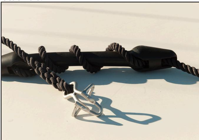
La main de fer et sa solidité à la rupture toute relative ne sera donc utilisé que dans une plage de vent conforme à une utilisation raisonnable: ce n'est pas une procédure pour affronter la tempête mais une bonne solution pour 90 % des cas de nos mouillages estivaux.
