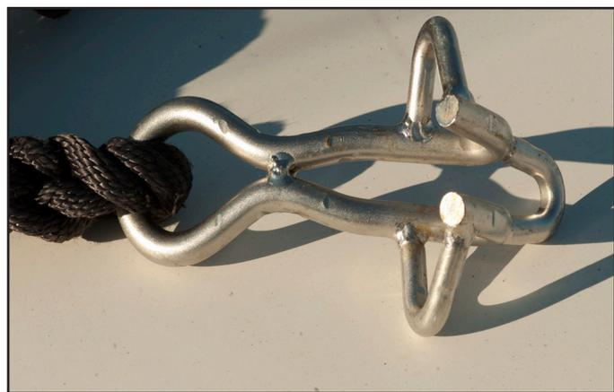
Une main de fer, c'est un crochet que l'on passe sur les maillons muni d'un bout que l'on frappe au taquet pour tenir le mouillage; on rallonge un peu la chaîne pour libérer le guindeau et l'affaire est faite, le bateau tient sur une amarre en
