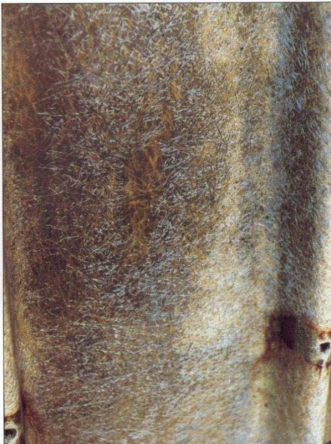
Photo 2-22 : fibre de verre blanche, lessivée de sa résine d'origine
