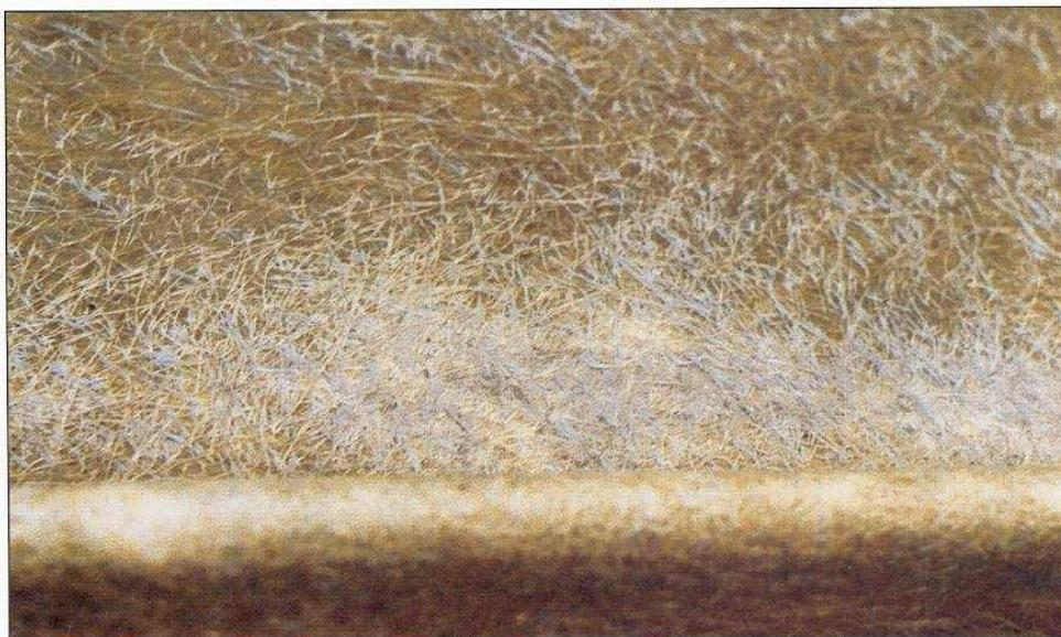
Photo 2-23 : il faut gratter l'anti-fouling pour que les petites bulles blanches apparaissent
