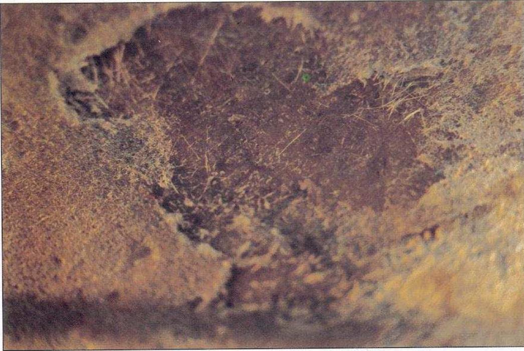
Photo 2-27 : éclats et fendillements d'un gelcoat pas assez souple
