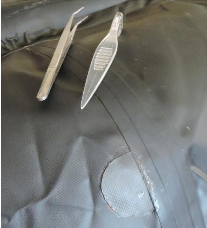
la pièce a été collé, mettre sous presse et préparer la pièce qui viendra en recouvrement
