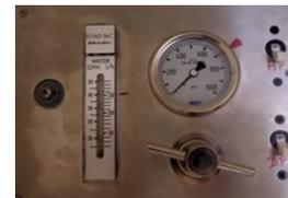
6/vérifier au débitmètre la production, attendre le passage des petites bulles d'air et caler la pression pour avoir sur votre système une production d'environ 140L/H (la pression doit se situer entre 50 et 55 bars avec des membranes neuves).
