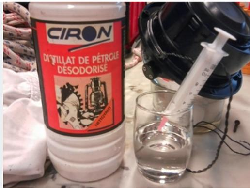
7. pousser un tout petit peu sur la membrane pendant que l'on replace la vis et que l'on revise à fond, retourner le compas doucement, si besoin renouveler l'opération, deux ou trois fois jusqu'à remplissage intégral.
