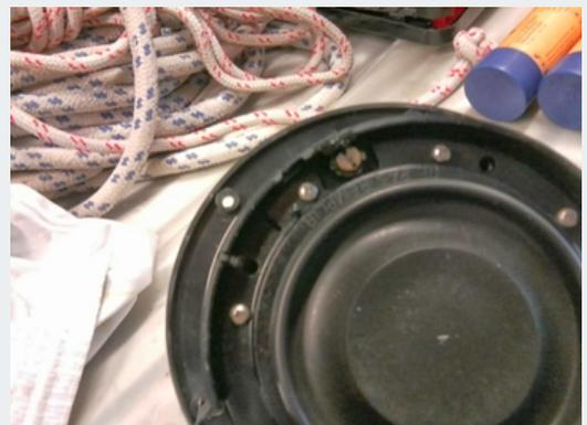
3. avec un tournevis plat on déclipse les 4 clips qui tiennent les deux parties ( désaccouplement des vis de réglages / du corps du compas). On accède alors à la membrane et on voit une petite vis droite en bronze.
