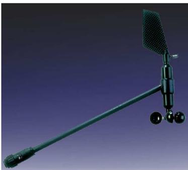
La girouette/anémomètre installée en tête de mât. Pour les anémomètres, la technologie à trois godets est la plus courante. Girouette et étoile à godets sont montées sur roulement, la vitesse du vent étant déduite du nombre de tours effectués dans un intervalle de temps fixé.
