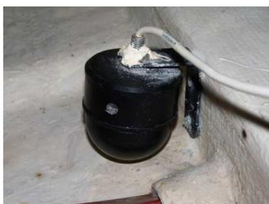
Le compas fluxgate pour être précis doit être monté loin des masses métalliques telles que moteur, ancre ou chaînes. Il est intéressant de le monter le plus près possible du centre de gravité du bateau afin qu'il soit moins exposé aux mouvements du bateau.
