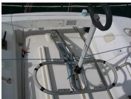
La raquette permet de compenser la relative largeur du bateau. Un *stick* (rallonge de barre télescopique ici) permet d'autre part au skipper de se positionner au rappel tout en barrant. On remarquera les deux taquets coinçeurs permettant d'amarrer la barre.
