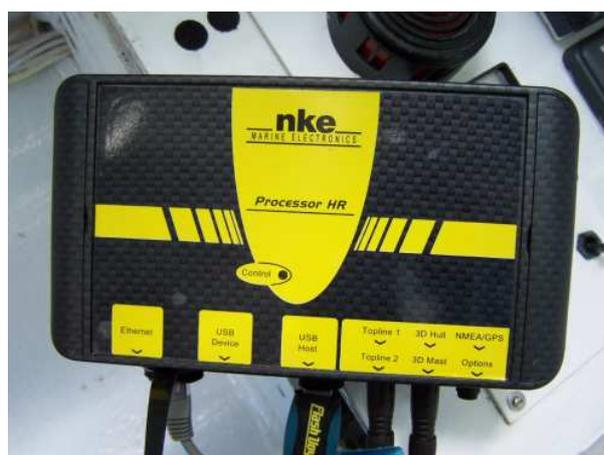
Le **processorHR** a été conçu à l'origine pour traiter les données de centrales inertielles à hautes cadences. Il prend finalement en charge la commande de barre et permet d'intervenir à façon sur l'ensemble de l'installation (on peut par exemple définir un autre graphisme pour les caractères ou symboles apparaissant sur les répéteurs).
