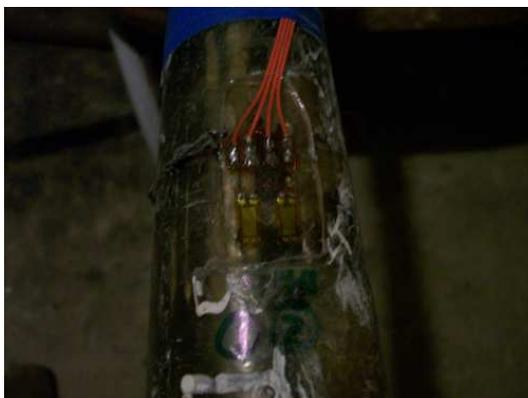
Deux des quatre jauges collées directement sur la mèche de safran. Un méplat a été pratiqué sur la surface conique de la mèche de safran car les jauges sont plates et doivent le rester si on veut conserver leurs caractéristiques techniques. Un autre méplat identique a été creusé de l'autre côté pour accueillir les deux autres jauges qui sont alors reliées entre-elles pour former un pont de Wheatstone.
