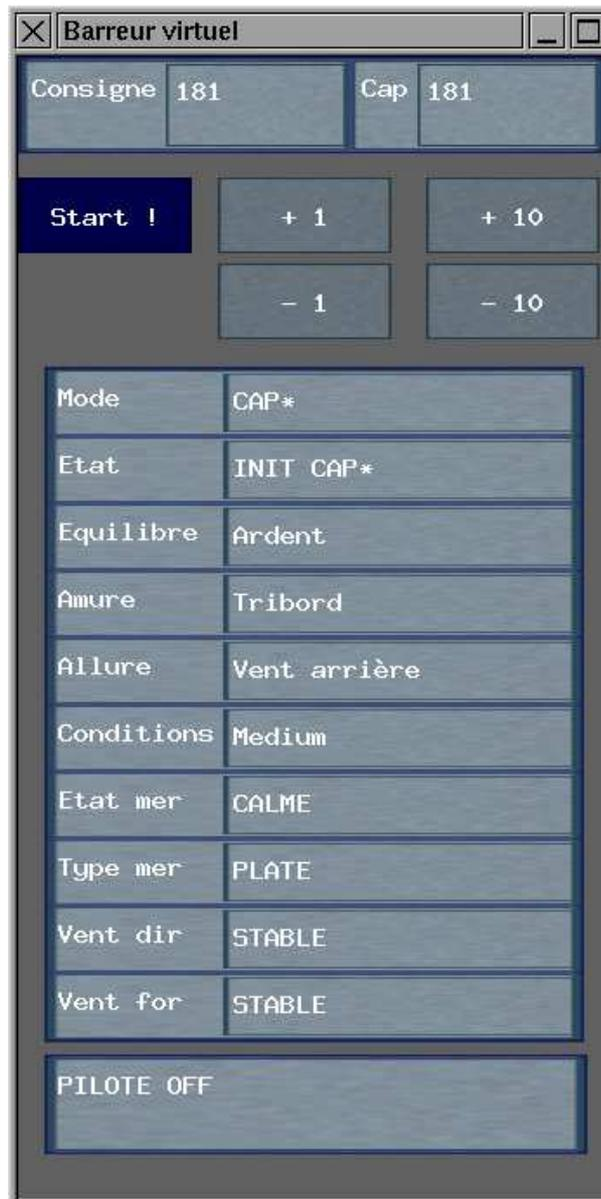
Ici le pilote est débrayé comme indiqué en bas de l'interface et la consigne suit le cap du voilier. Dans les conditions présentées dans la figure 5.1 précédente on peut lire que le bateau est ardent, tribord amure, que nous sommes au vent arrière dans un vent médium avec une mer calme et un vent stable en direction et en force.
